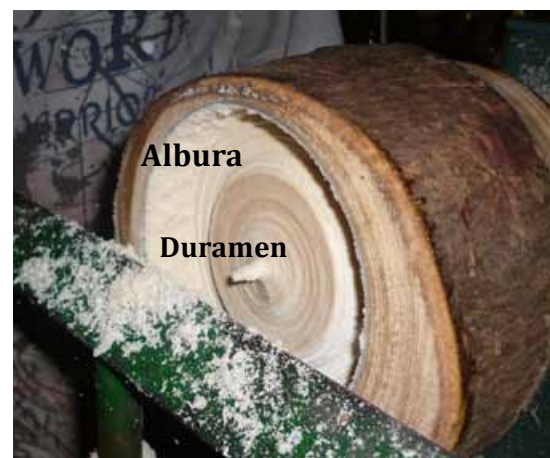
Figura N° 2. Albura y duramen del corte transversal.
